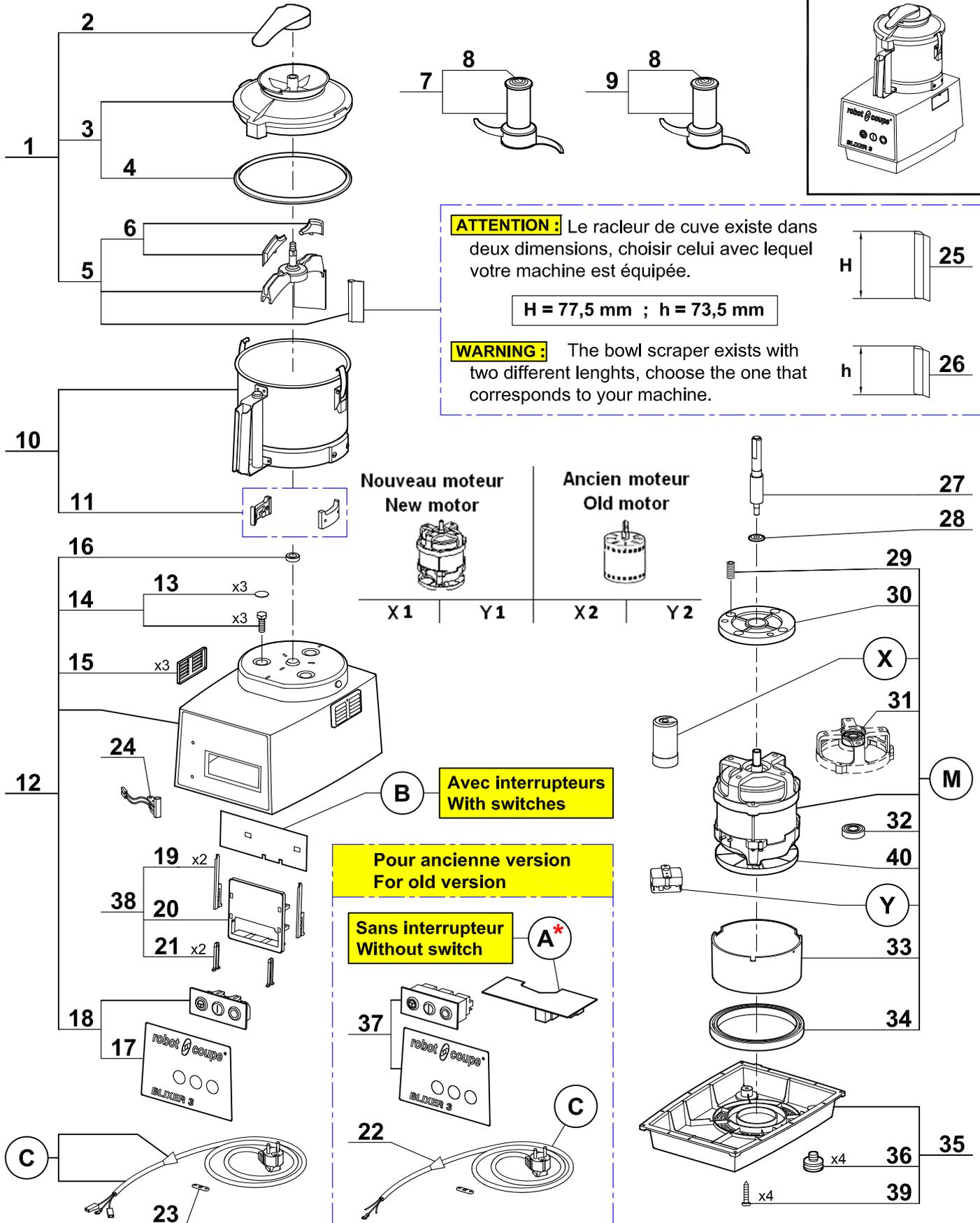
KIT DE MISE À NIVEAU OBLIGATOIRE POUR LES MODÈLES 100V ET 120V ÉQUIPÉS D'UNE PLATINE SANS INTERRUPTEUR. Comprend les pièces avec les index suivants: 18 , 19 (Qté = 2) , 20 , 21 (Qté = 2) , B et C.
