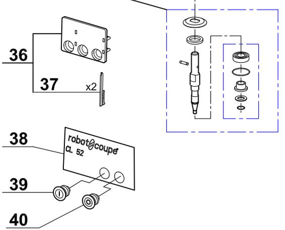
**ATTENTION :** Il existe 2 configurations au niveau de l'arbre de transmission et des joints d'étanchéité associés. Choisir parmi les repères 1 à 4 ou 5 à 8, selon la hauteur des **plats d'entraînement** de l'arbre de transmission sur votre machine.
